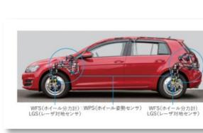
車載統合計測システム (VMS)
