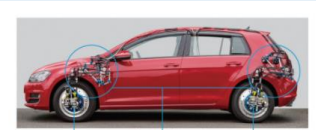
WFS(ホイール力計) LGS(レーザー対称センサ) WPS(ホイール姿勢センサ) WFS(ホイール力計) LGS(レーザー対称センサ)
