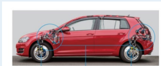
WFS(ホイール分力計) WPS(ホイール姿勢センサ) WFS(ホイール分力計) LGS(レーザー対地センサ) LGS(レーザー対地センサ)
